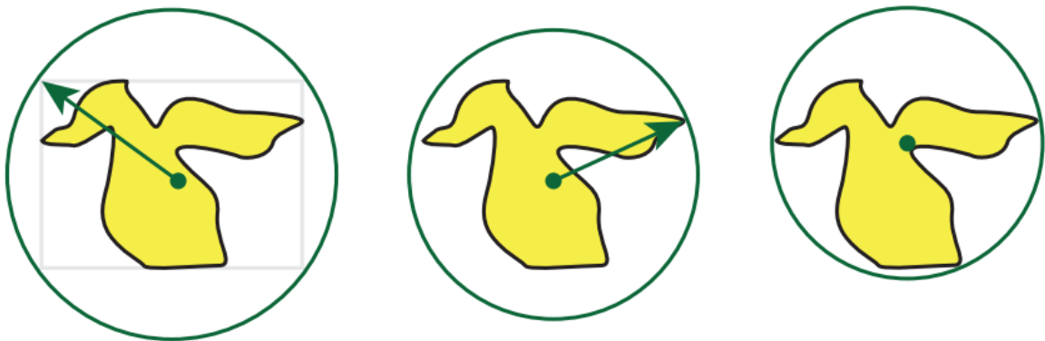
图 22.7：包围球。左边是最简单的方法，先构建这个物体的包围盒，然后再使用这个包围盒的外接球来作为这个物体的包围球。左边这种简单方法会出现很多冗余的空白空间，可以将这个包围盒的中心作为包围球的中心，然后再遍历所有顶点，来找到距离球心最远的顶点，并将这个距离作为包围球的半径，这样可以对包围球进行一些改进，如中间图像所示。如右图所示，可以通过移动球体的中心来进一步减小包围球的半径。
